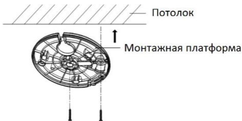
Рисунок 2-3 Установка монтажной платформы
