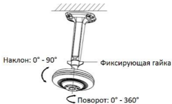
Рисунок 2-19 Настройка угла наблюдения
